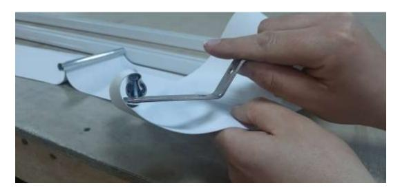
Глайдер приходит в разобранном виде. Направляющая часть крепится винтом на трубку.
