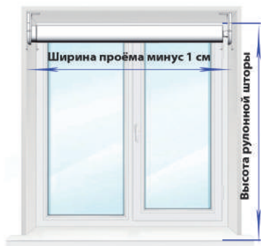
Монтаж карниза в проём окна
